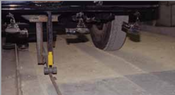
1996 – Tensor geonätens ökade lastspridningsfunktion leder till betydande minskning i spårdjupet .
