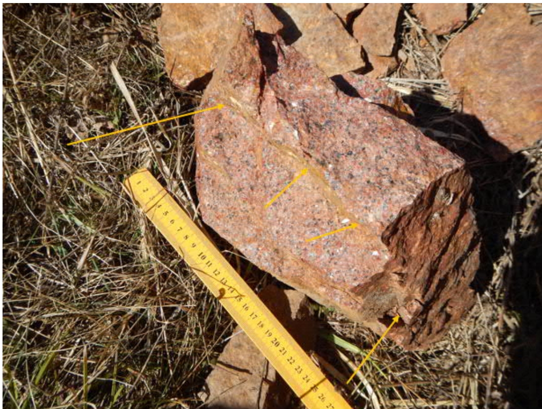
Figur B1:1. Subtila sprickor i lösgjord stuff, Prästö (gula pilar), med vittrade sprickytor.
