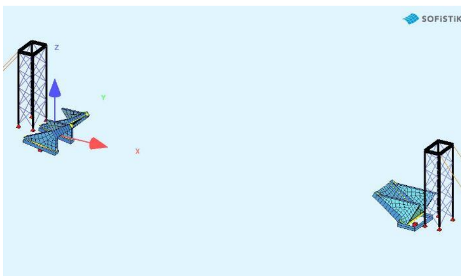
Figur 35 Steg 9, rivning av bågar och transversaler.
