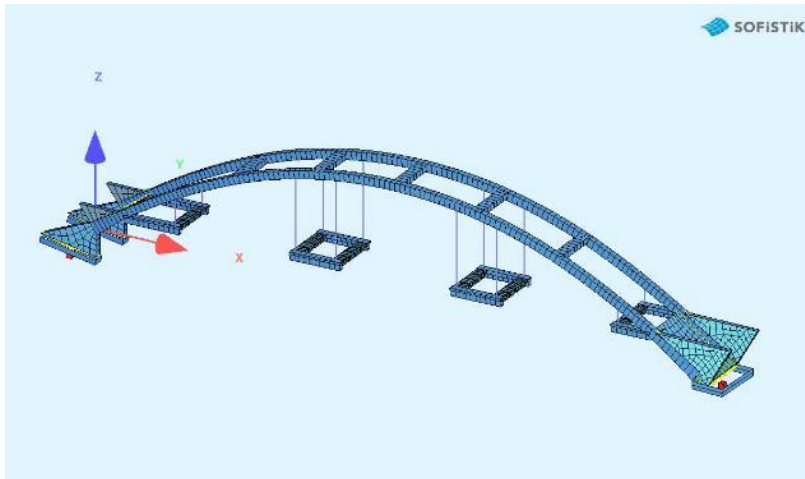
Figur 20 Steg 9, rivning av balkar och stag.
