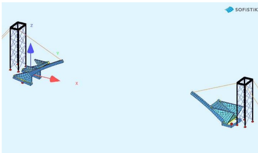
Figur 34 Steg 8, rivning av bågar och transversaler.
