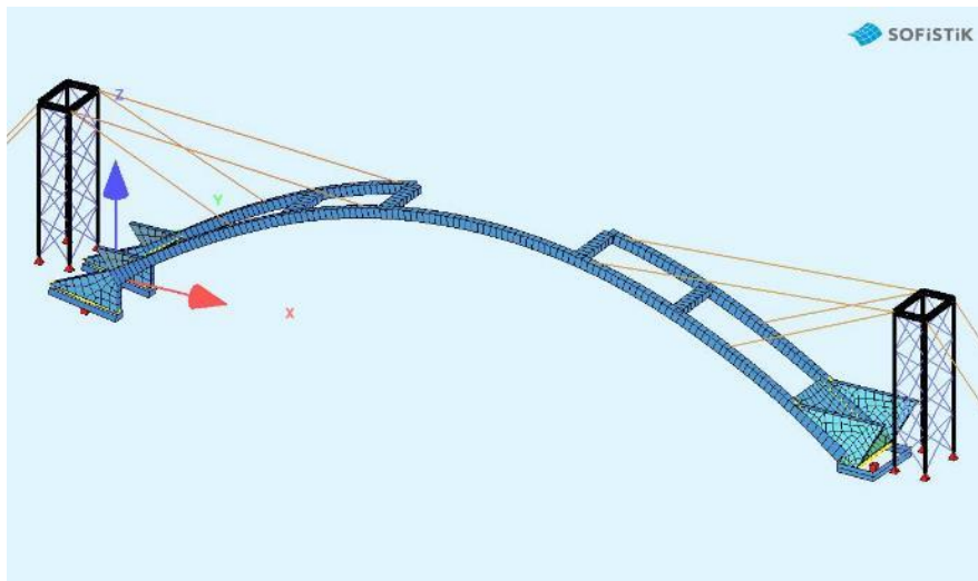
Figur 28 Steg 2, rivning av bågar och transversaler.
