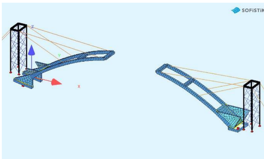
Figur 29 Steg 3, rivning av bågar och transversaler.
