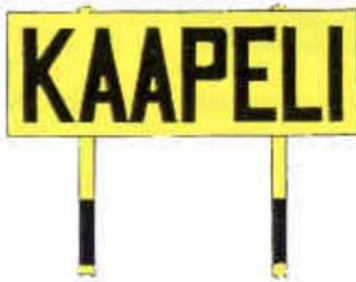
Figur 33. Kabel- och ledningstavla (bilden visar en kabeltavla)
