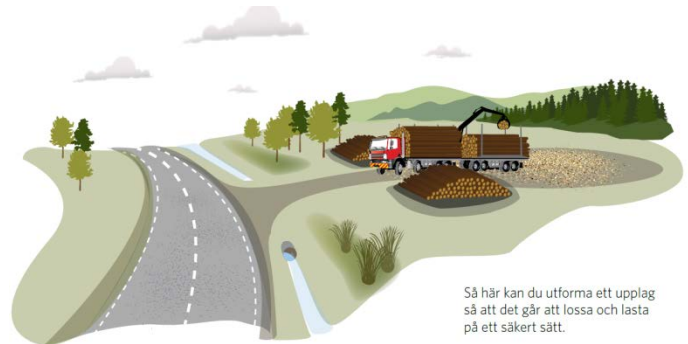
Bild 1. Lossning och lastning från en mindre väg. (Illustration: Trafikverket Sverige)
