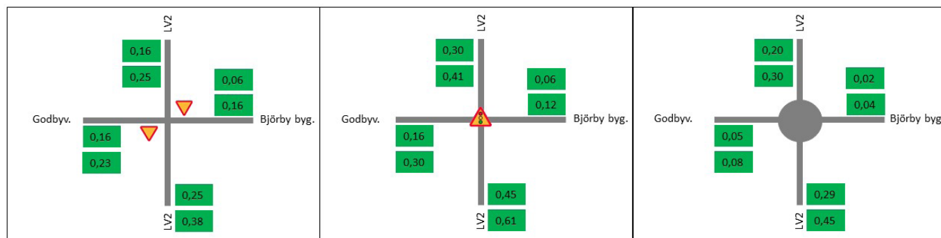
Figur 50. Belastningsgrader vid Björsbykorsningen. De övre rutorna avser belastningen i nuläget och de undre rutorna avser år 2040.
