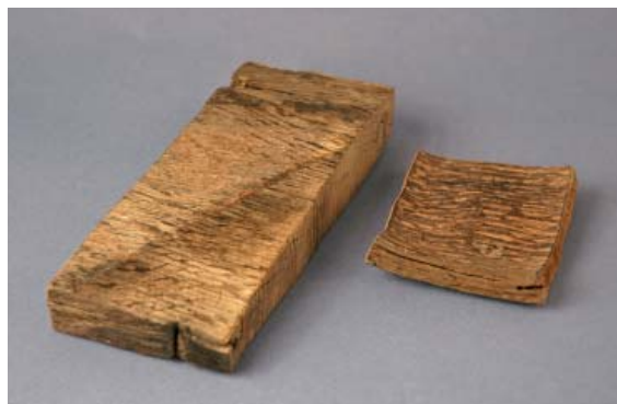
De två trästyckena var från början i samma storlek. Trästycket till vänster har konserverats. Trästycket till höger har fått torka okontrollerat utan någon konservering och har därmed deformerats och fullständigt förlorat sin ursprungliga form. Foto: Riksantikvarieämbetet
