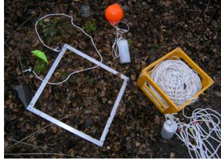
Inventeringskit med lina i förvaringsback, provruta och boj med tyngd.
