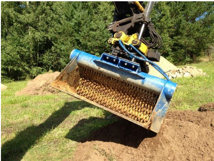
Figur 20. Grävlastarens sorteringskopa med vilken schaktmassor i åkermark sållades. Bilden är från undersökningen av fornlämningen Sa 20.7 Alkärr år 2017, då metoden först introducerades. Foto: 1170822_01 Jenni Lucenius.
