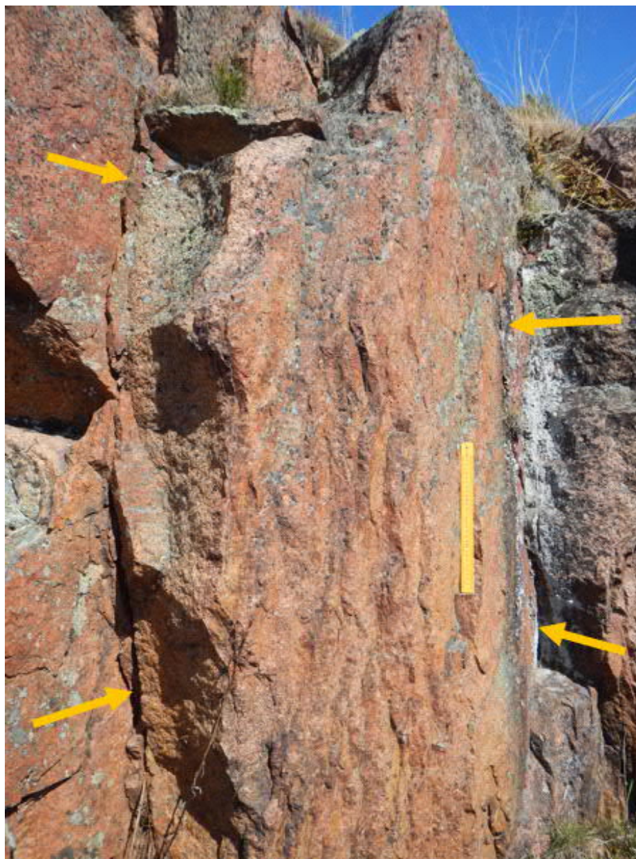
Figur 10. Subvertikal sprickzon, vars avgränsningar visas med gula pilar. Den gula linjalen i bild, är 32 cm lång och 2,8 cm bred, för skala och ligger parallellt sprickplanen. Som syns på bilden kan sprickavståndet i delar av zonen vara så tätt som 20-40 mm.
