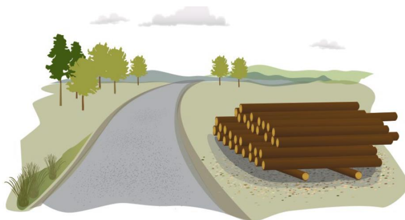
Bild 4. Trafiksäkert upplagd vält. Utformningen förhindrar att enskilda stockar tränger in i kupén på en bil som kolliderar med vältan. (Illustration: Trafikverket Sverige)
