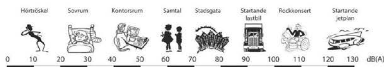
Figur 5.18 En illustration av olika ljud och deras ungefärliga ljudstyrka. Källa: Svenska Trafikverket.
