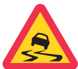
A10 Varning för slirig väg
