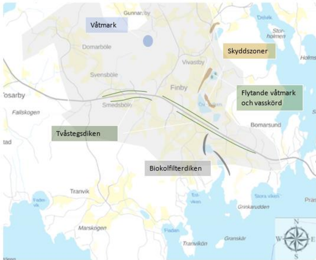
Figur 3. Karta över föreslagna specifika åtgärder mot övergödning i Finby delavrinningsområde. Figurerna är inte skalenliga. Karta från Ålands vattenmiljöer. Ann-Sofi Lenander 2020.
