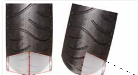
fig. 2 Hjulets omkrets är mindre vid däckets kant. Framgaffelns geometri och däckets runda profil gör att en motorcykel automatiskt svänger när den lutar.
