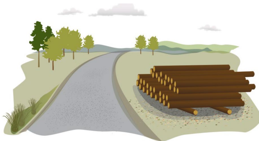
Bild 5 - trafiksäkert upplagd vältan. Utformningen förhindrar att enskilda stockar tränger in i kupén på en bil som kolliderar med vältan. (Illustration: Trafikverket Sverige)
